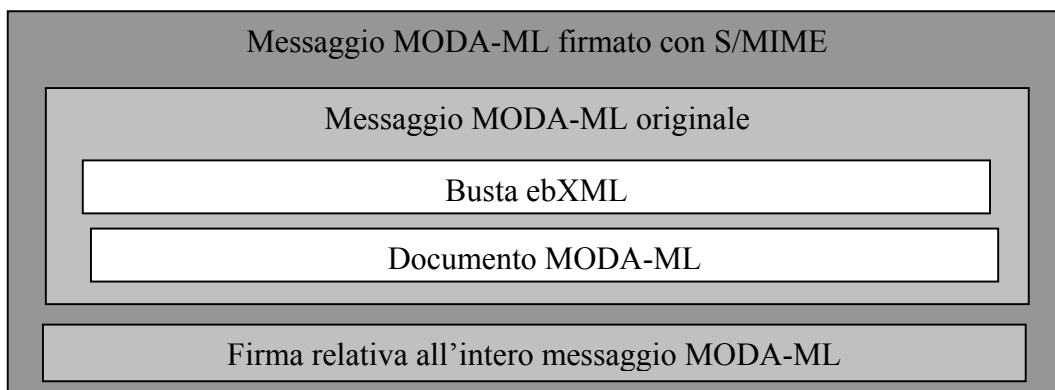
Figura 4.1: Struttura del messaggio firmato con S/MIME
